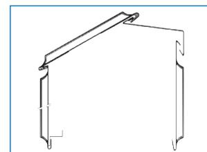
Encocheuse à joint debout pour la finition en arrondi à la gouttière ou au faîtage mono-pente.
