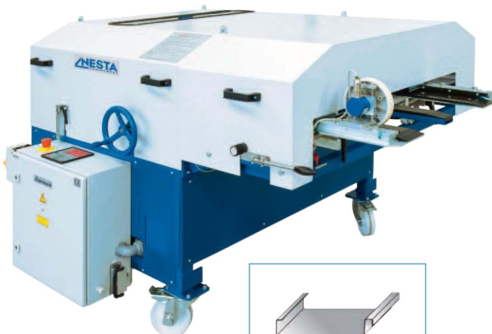
Profileuse à joint debout avec coupe automatique avant profilage. Les bacs de même longueur peuvent être profilés en automatique pour que seul un opérateur les réceptionne et conditionne à la sortie.
