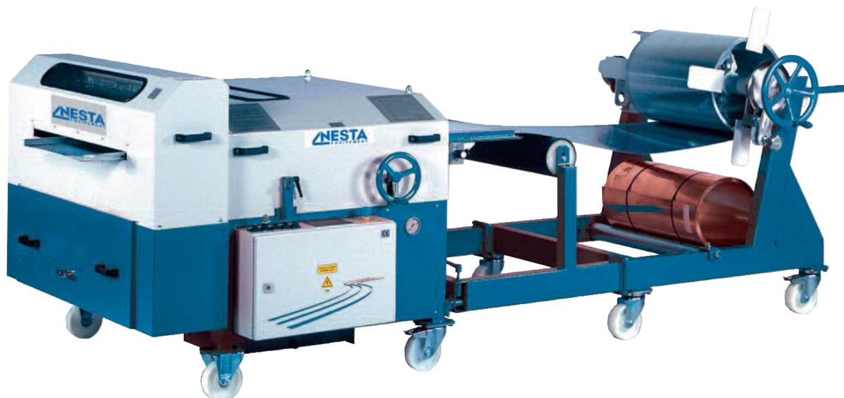
Profileuse à joint debout avec galets surdimensionnés pour un profilage plus progressif et de qualité supérieure.
