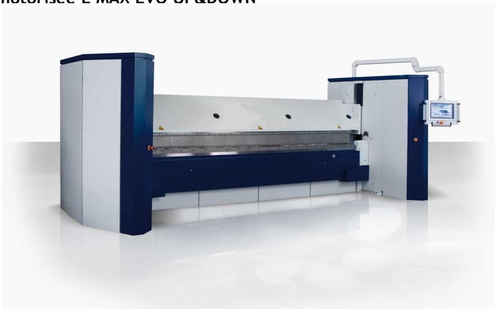
Plieuse électrique (panneauteuse) très performante issue des dernières innovations pour une précision et une vitesse de travail optimale. Commande à écran tactile et graphique Pos 3000 avec simulation des profils en 3D.
