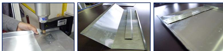
Clincheuse pneumatique sur pied vous permettant d'assembler très rapidement de nombreuses tôles entre elles. Permet de raccorder différents types de métaux sans aucune soudure et points de chauffe.
