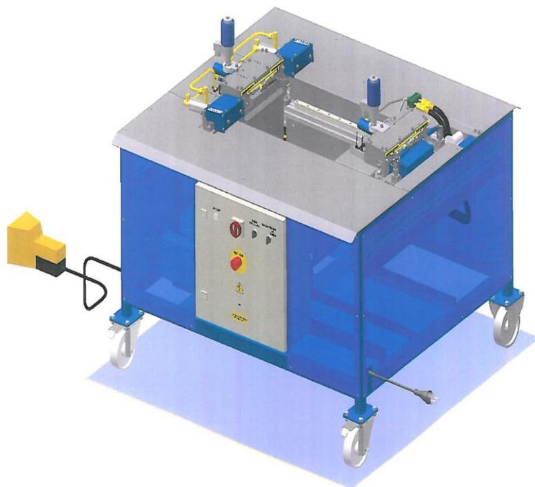
La machine électrohydraulique **ELE 90** est prévue pour l'encoche d'égout à joint debout en finition arrondie (Languette étirée).
