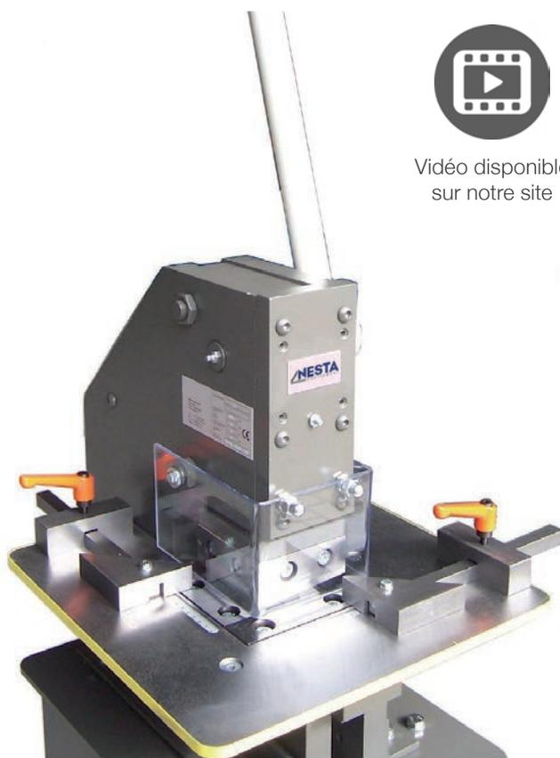
**Machine idéale et pratique pour la fabrication de cassettes de bardage, tablettes de fenêtre, couvercles, écailles, ...
