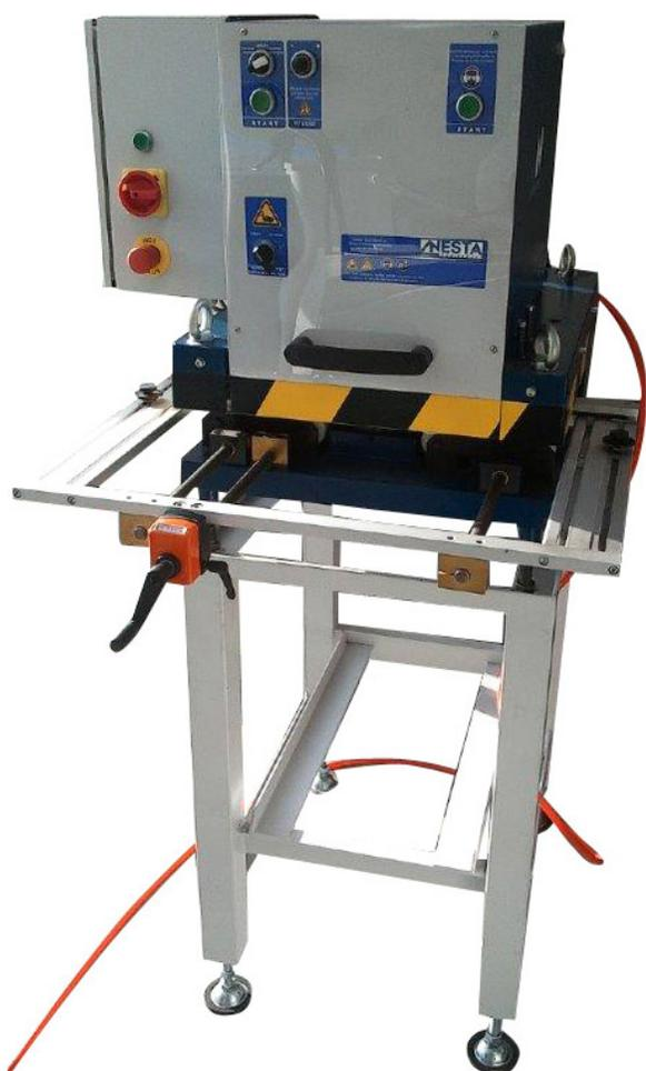
**Permet la perforation de bandes de tôle pré-découpées en cuivre, zinc, acier ou aluminium.**
