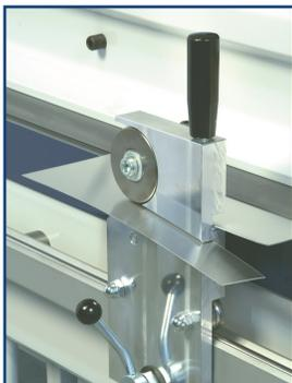
Outil de coupe avec guidage linéaire sur rail aluminium, capacité 0,8 mm (zinc)
