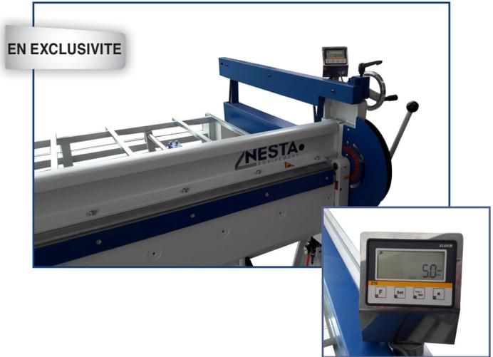
Butée arrière réglable par l'avant de 750 mm avec table porte pièces et afficheur digital de la profondeur.
