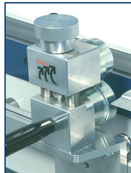
Outil de soyage avec guidage linéaire sur rail aluminium ou guidage sur rail supérieur.
