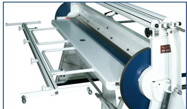
Baguetteuse manuelle à fixer sur le tablier de pliage (uniquement en 2 m et 2,5 m)
