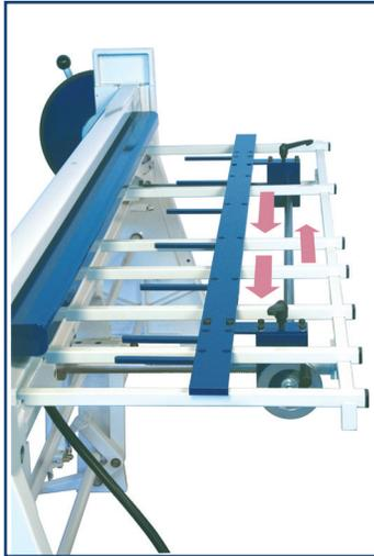
Butée arrière manuelle à crémaillère de 750 mm avec table porte tôle.
