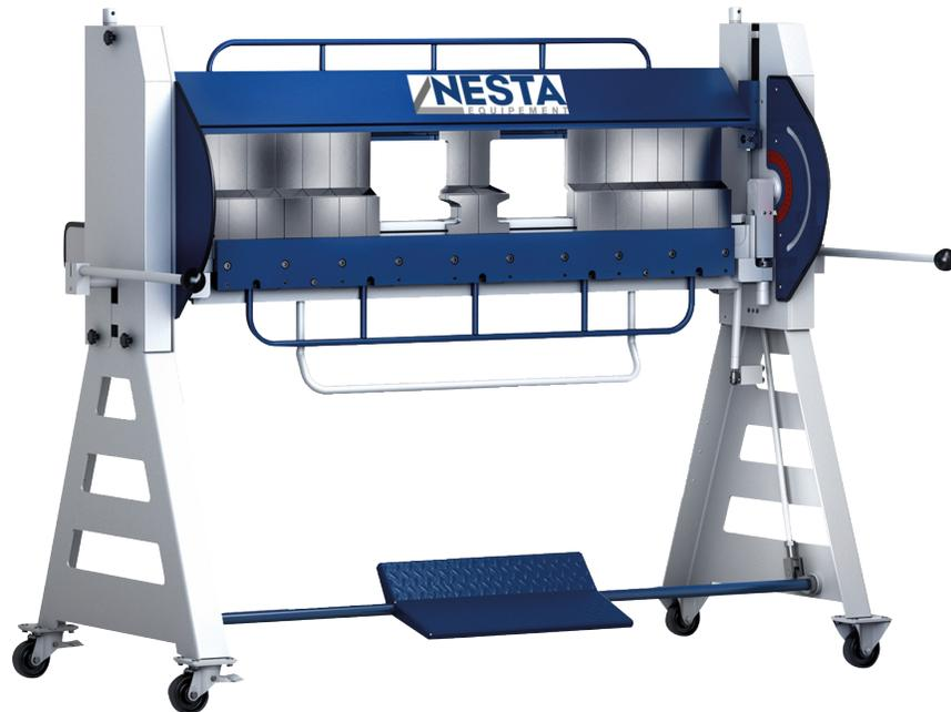
**Pliieuse idéale pour la fabrication de boîtes à eau, pour les cassettes de bardage et larmiers à joint debout. Système de serrage des outils breveté pour déplacer vos segments très rapidement. <sup>1</sup> Molette de réglages de pression selon l'épaisseur du matériau. Possibilités de monter des segments avec plus de hauteur en options.**
