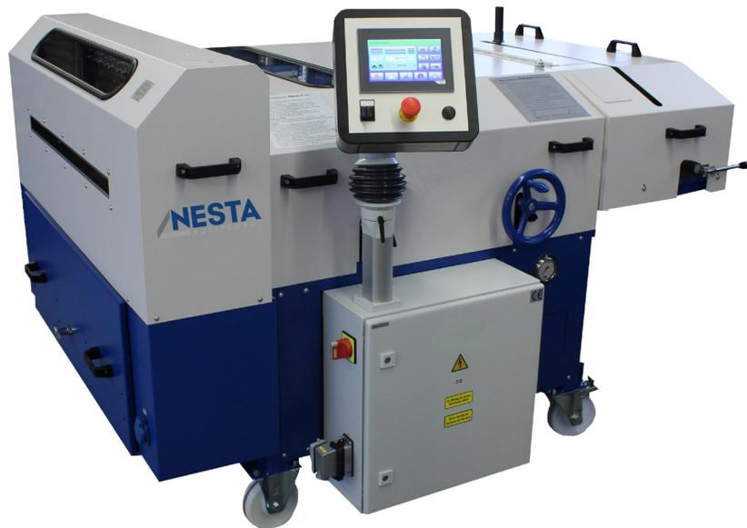
**Profileuse à joint debout avec galets et pignonne surdimensionnés pour une qualité de profilage supérieure et une durée de vie prolongée.**
