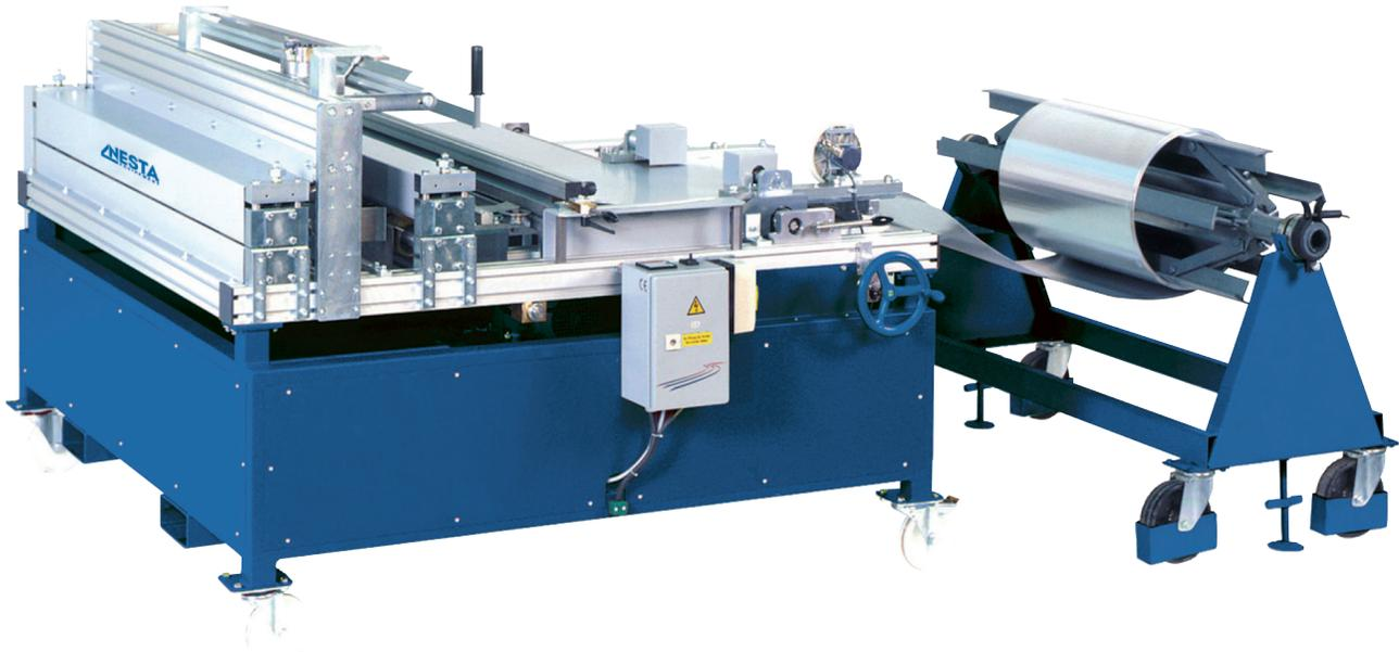
**La refendeuse RC est la machine idéale pour toutes vos découpes parallèles, obliques et trapézoïdales. Une commande programmable simple d'utilisation calcule la position et l'angle de la tête de coupe mobile. [1] Lors de l'avancement du matériau, la tête de découpe se déplace transversalement. [2]**
