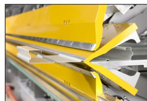
**Plieuse hydraulique à pliage positif et négatif alliant rapidité, flexibilité et innovation.**
