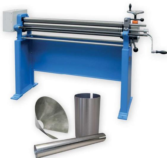
**Large gamme de rouleuses, de 230 à 2030 mm de longueur utile, capacité de 0,4 à 3,2 mm**
