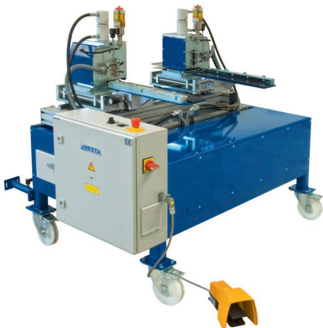
Permet l'encochage du profil SOFIT PANEL pour fermer les extrémités de cassettes par la suite sur votre plieuse à segments.
