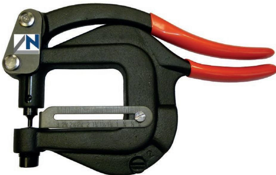
*Poinçonneuse portative manuelle en valisette, idéale pour le chantier.*
