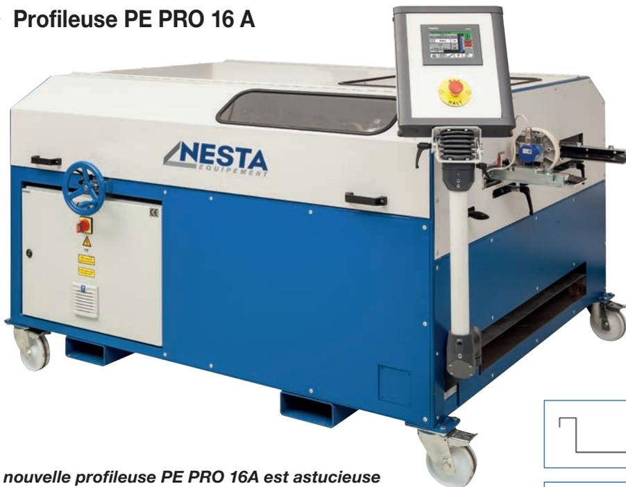
**La nouvelle profileuse PE PRO 16A est astucieuse grâce à ses cassettes pivotantes permettant le profilage de bacs de départ en une passe ou pour faire 2 profils 45 mm. 1**
