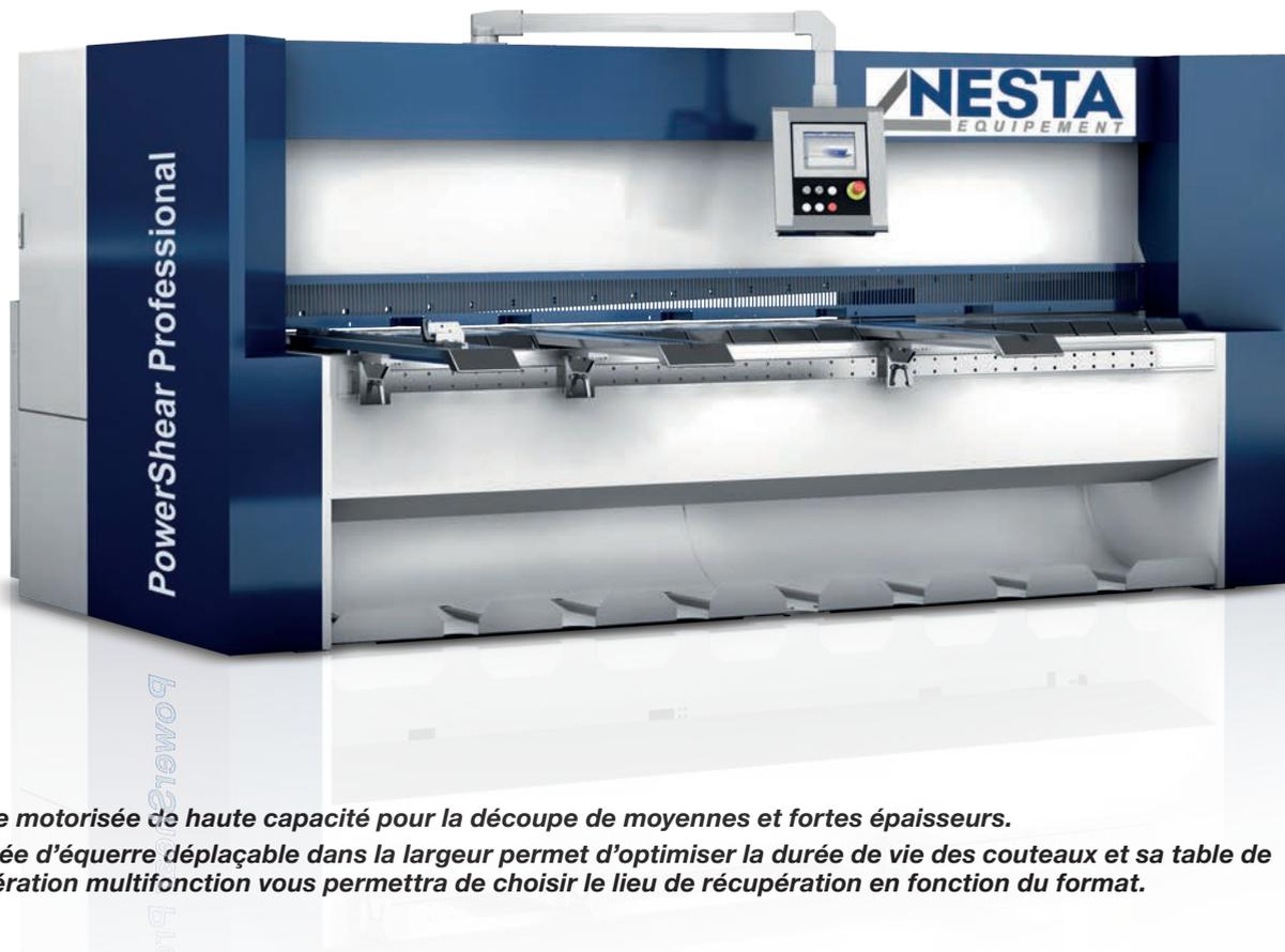
**Cisaille motorisée de haute capacité pour la découpe de moyennes et fortes épaisseurs.**
