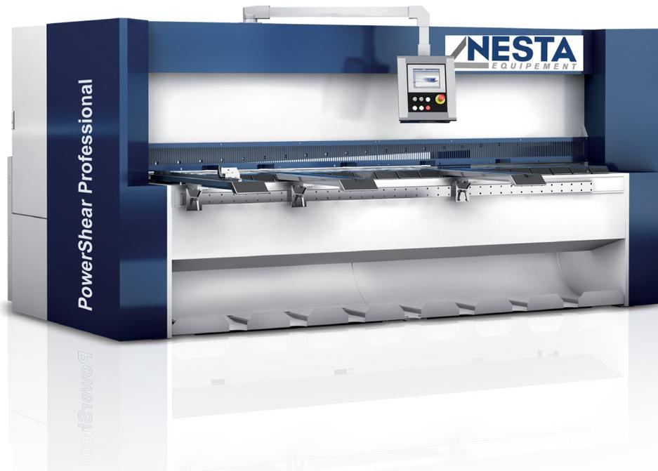
**Cisaille motorisée de haute capacité pour la découpe de moyennes et fortes épaisseurs. Sa butée d'équerre déplaçable dans la largeur permet d'optimiser la durée de vie des couteaux et sa table de récupération multifonction vous permettra de choisir le lieu de récupération en fonction du format.**
