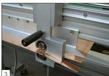
**Plieuse segmentée en partie haute, légère pour le chantier avec la possibilité de pliage négatif pour la réalisation des larmiers sur vos bacs à joint debout sans retournement.**
